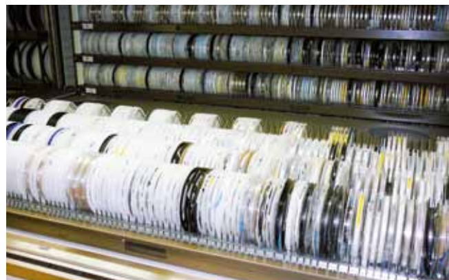
Lochraster mit Steckvorrichtung zur Lagerung von SMD-Rollen
