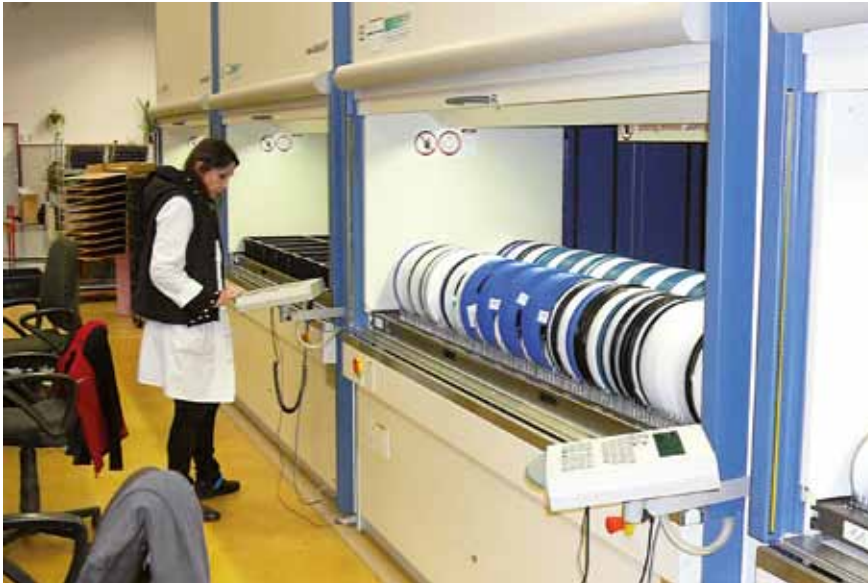
Ein- bzw. Auslagerung in ergonomischer Höhe von 900 mm
