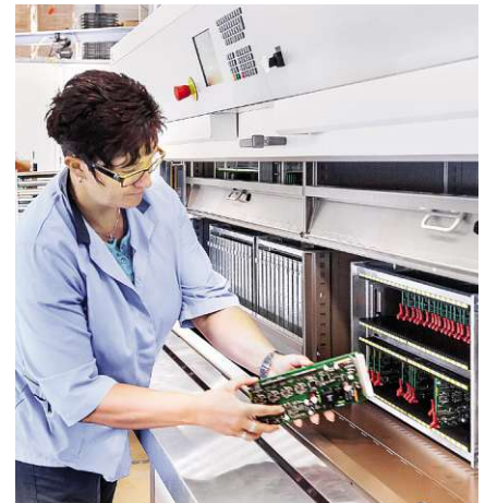
Das flexible Umlaufersystem ist direkt an der Produktionslinie integriert.
