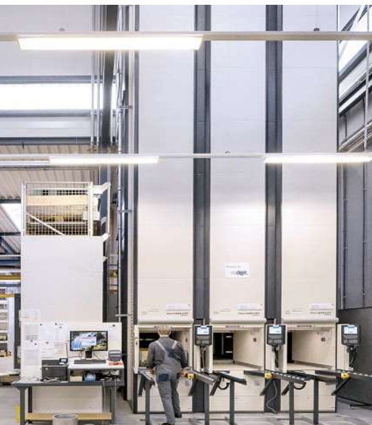
Im neuen Gebäude von Sitema wurden 15 Meter hohe Hänel Lagerlifte vom Typ Lean-Lift installiert.
