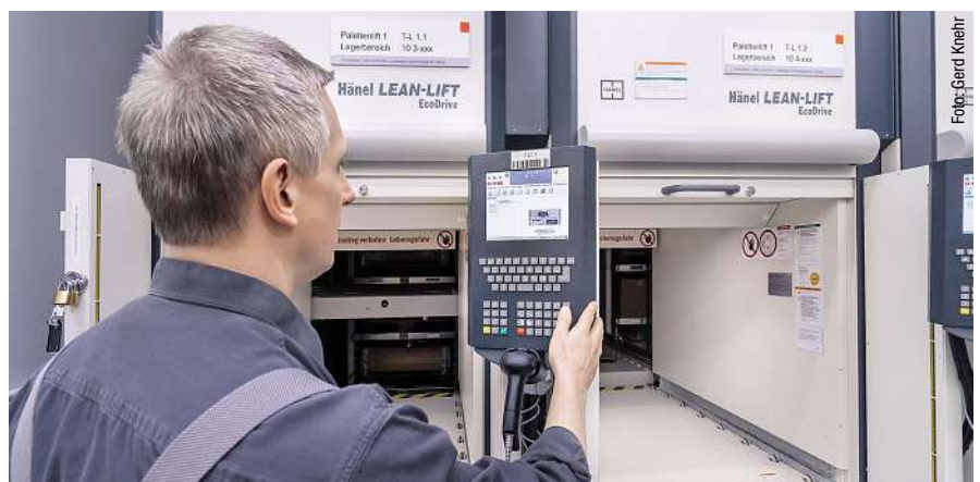
Die Auftragsposten am jeweiligen Terminal der Entnahmestelle werden mit dem viadat User Interface Schritt für Schritt abgearbeitet.
