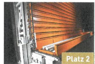
wie Boxen, Paletten oder Werkzeugen erwerben. Diese Lastaufnahmemittel besitzen eine Tragfähigkeit von jeweils bis 3 t. Gelagert werden können Stangen, Rohre, Profile und Vollmaterialien bis 6,5 m.
